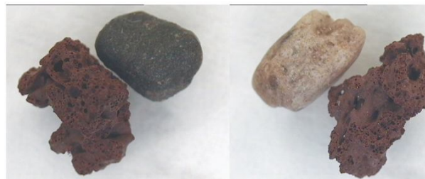
图3 相同粒径下砂土与模拟月壤颗粒对比图
